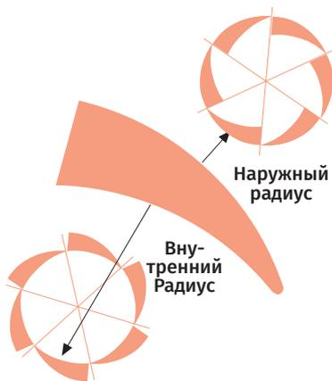
Радиус данного инструмента приводит к пробитым деталям с более плавными кромками, изготовленными с гораздо меньшим количеством ударов, чем с использованием обычного циркульного пуансона. Этот инструмент можно программировать для пробивки отверстий с вырубными пластинами или с частями, удерживаемыми перемычками в листе, но их можно легко отделить друг от друга без пресса.
