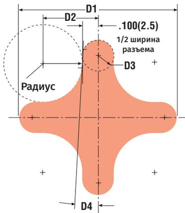
Инструмент 4-х сторонней Радиусной обработки углов может вращаться вокруг всех четырех углов детали без вращения инструмента. Использовать со стандартными инструментами разреза для отделения деталей.
