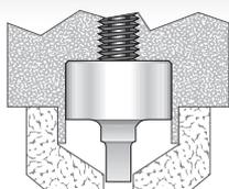
Профиль уретанового съемника для прямоугольных пуансонов - усилены две стенки
