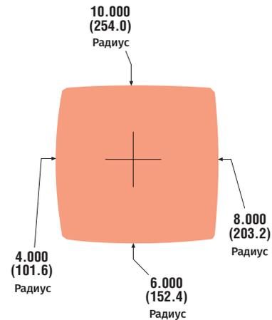
Инструмент с четырьмя радиусными сегментами - Quad Radius – высекает большие отверстия с более ровными краями и с меньшим количеством ударов, чем при использовании круглого высечного пуансона. Гладкие круглые отверстия не ограниченные диапазоном станции.
